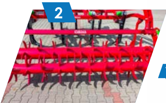
Szerokość robocza: 2,80 m (wał kolczasty).
