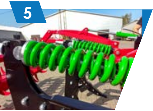
Zabezpieczenie sprężynowe podwójne. Typu non-stop.
