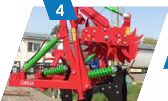
Wał hydraulicznie zakładany na maszynę tzn. składa się na maszynę.
