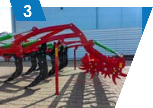
Podwójny wał kolczasty z możliwością regulacji konta.
