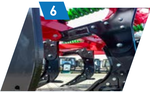
Słupica ze stali Durostat.
